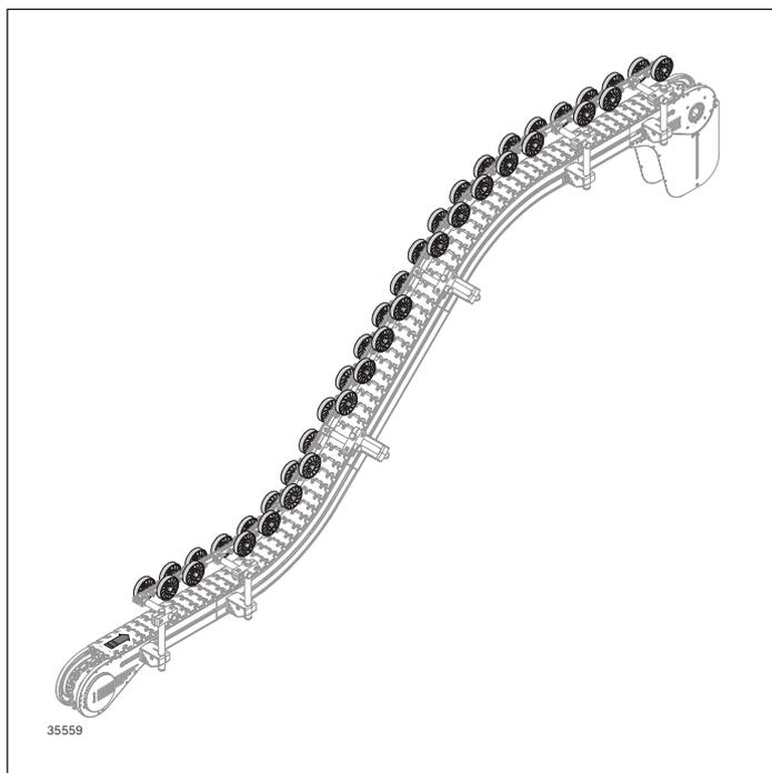
Permite un transporte vertical económico de productos ligeros. La presión de apriete ejercida sobre la cadena de transporte plana permite aumentar el rozamiento y, por tanto, un transporte seguro en tramos verticales.
